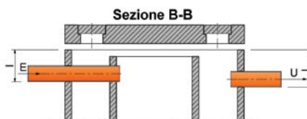
Sezione coperchio per fosse DN 1000
